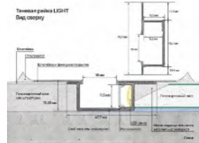
Узел 3. Устройство профиля (разрез вид сверху) Узел 2. Устройство конструкции из ГКЛ с подсветкой (разрез вид сверху)
